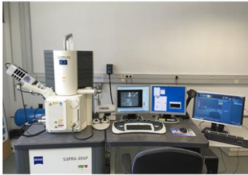
Figura 1.2: Esquema de funcionamiento de un microscopio electrónico de barrido (adaptado de la página: www.microscopioelectronico.top ) y fotografía del equipo utilizado.
