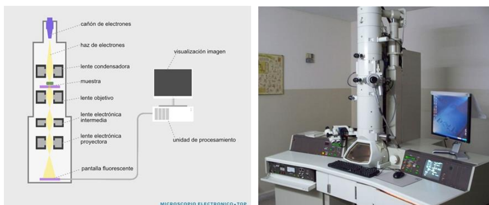
Figura 1.1: Esquema de funcionamiento de un microscopio electrónico de transmisión (adaptado de la página www.microscopioelectronico.top ) y fotografía del equipo JEM 1200EX II, Jeol (Jeol, Tokio, Japón).
